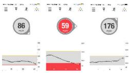
Básicamente consiste en un sensor subcutáneo de glucosa del tamaño de un cabello grueso, un transmisor y un receptor inalámbrico, que muestra de manera continua los valores de glucemia refrescando el dato cada 5 minutos; pero además la configuración "MOBILE" permite recibir los resultados sobre un dispositivo móvil y reenviar los datos en tiempo real hasta dispositivos de otras cinco personas para su seguimiento. El receptor en
